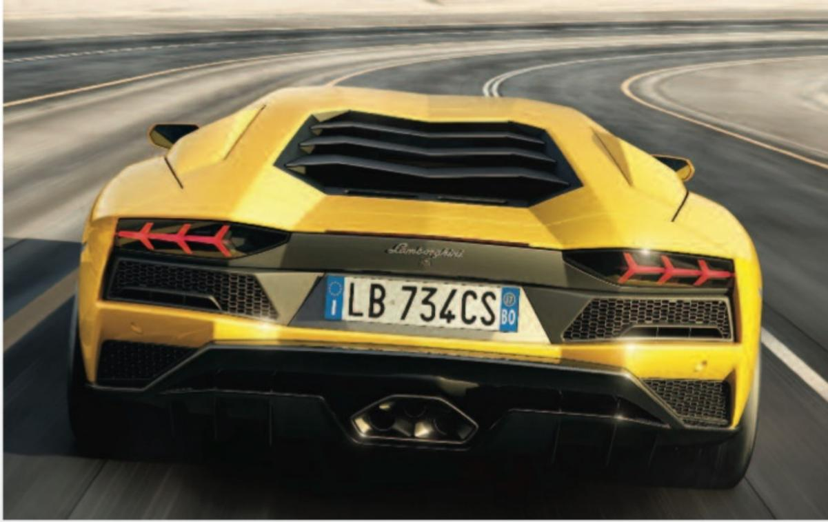
el caso del alerón trasero, el cual se puede ajustar en tres posiciones distintas, mejora el "downforce" en un 50% en modo "óptimo" y hasta 400% en "baja resistencia".
